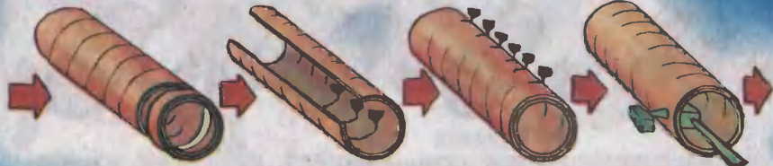
СВАРКА ВНУТРЕННИХ КОЛЬЦЕВЫХ ШВОВ
